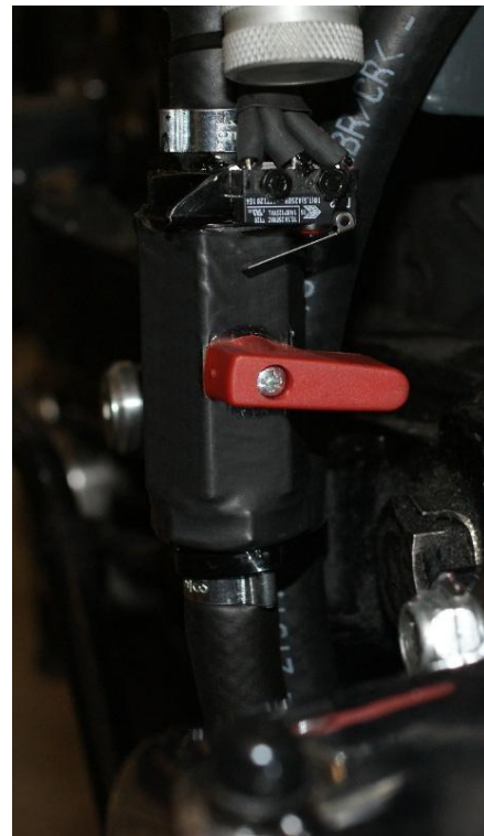
Absperrhahn in der Ölleitung zum Motor - Absperrhahn geschlossen - Ölfluss unterbrochen - Schalter nicht betätigt - Warnton bei Zündung "EIN"
